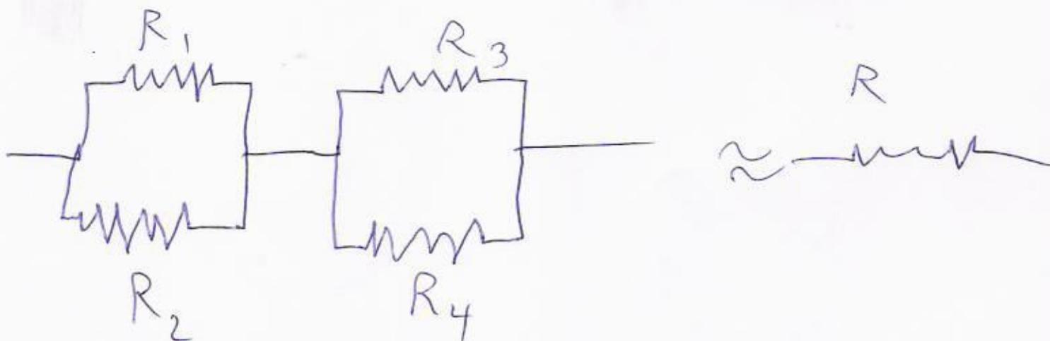
$$R = (R_1^{-1} + R_2^{-1})^{-1} + (R_3^{-1} + R_4^{-1})^{-1}$$
